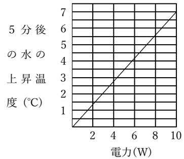
実験より、発生する熱量は、電流を流した時間と電力に **比例** する。
