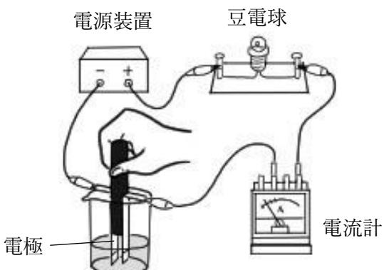
上の図のように、精製水に電流が流れるかどうかを調べ、その後以下の物質に電流が流れるかどうかを調べた。
